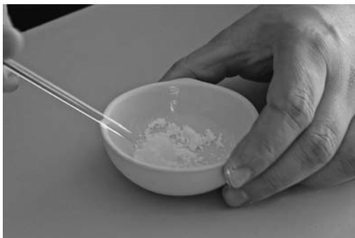
Рис. 4. Перемешивание силикона и «Детской присыпки»
