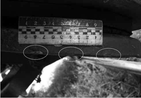
Рис. 5. Характерні пошкодження розвантажувальних люків вагона-хопера
