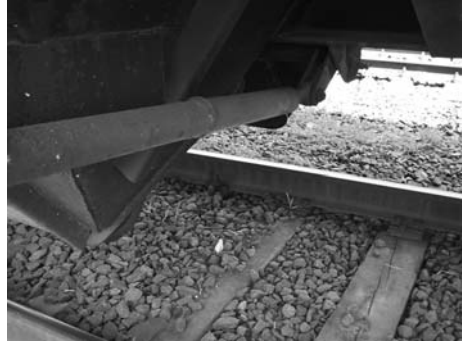
Рис. 3. Розташування розвантажувальних люків у вагоні-хопері
