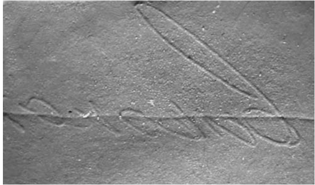
Рис. 2. Збільшене зображення рельєфного відбитка на пластиліні рукописного запису та горизонтальної лінії, розташованих з різних боків одного аркуша, штрихи яких перетинаються (копіювання штрихів проводилось з боку рукописного запису). Горизонтальний штрих — верхній (цільний), рукописний запис — нижній (переривчастий)
