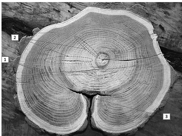
Рис. 2. Загальні та окремі ознаки на поверхні розподілу деревини: 1 — річні кільця, 2 — кордони ядра і заболоні, серцевинні промені, 3 — вади деревини
