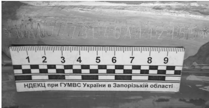
Рис. 1. Зображення номерного майданчика кузова автомобіля AUDI A4, 2005 року випуску, після проведення дослідження методом електрохімічного травлення (символи встановленого первинного заводського ідентифікаційного номера та кустарно нанесені символи ідентифікаційного номера візуально різняться)
