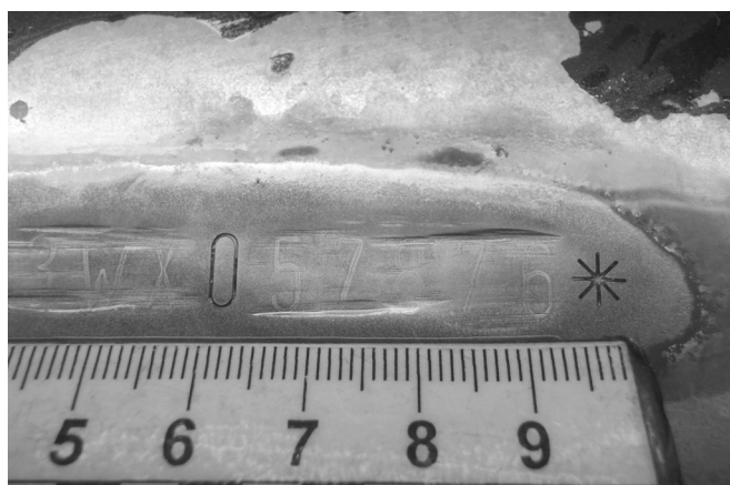
Рис. 5. Зображення фрагмента номерного майданчика кузова автомобіля SKODA OCTAVIA, 1998 року випуску, після проведення дослідження методом електрохімічного травлення (символи встановленого первинного заводського ідентифікаційного номера та кустарно нанесена частина символів ідентифікаційного номера візуально різняться)
