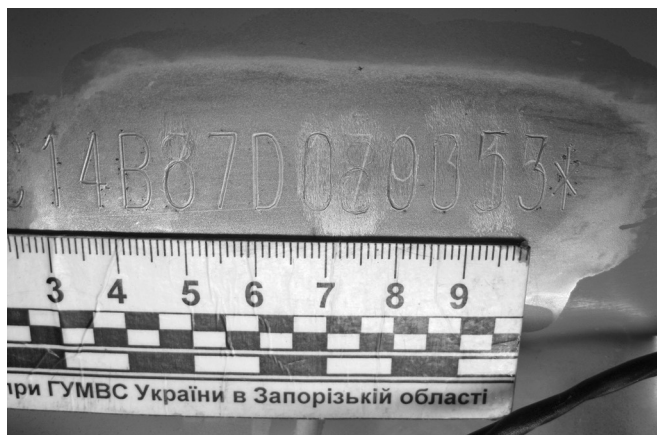
Рис. 4. Зображення номерного майданчика кузова автомобіля CHERY ELARA, 2009 року випуску, після проведення дослідження методом електрохімічного травлення (символи встановленого первинного заводського ідентифікаційного номера та кустарно нанесені символи ідентифікаційного номера візуально різняться)
