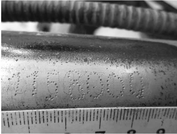
Рис. 2. Зображення фрагмента номерного майданчика рами мопеда VIPER, 2008 року випуску, зі зміненим ідентифікаційним номером після проведеного дослідження методом електрохімічного травлення
