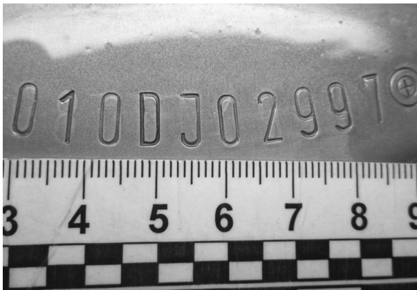
Рис. 3. Зображення номерного майданчика кузова автомобіля BMW 735, 1998 року випуску, після проведення дослідження методом електрохімічного травлення (символи встановленого первинного заводського ідентифікаційного номера та кустарно нанесені символи ідентифікаційного номера візуально різняться)
