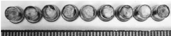
Рис. 2. Ватяні пижі, порох та гільзи, у яких їх розміщено
