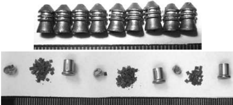
Рис. 1. Кулі та гільзи із зарядами пороху, що знаходилися в камерах барабана
