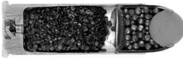
Рис. 13. Спеціальний пістолетний патрон Special Glaser калібру 9 мм американської компанії COR-BON/Glaser Ammunition
