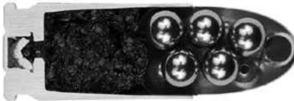
Рис. 14. Пістолетний патрон Sky Marshall калібру 9x19 мм (Luger/Parabellum)
