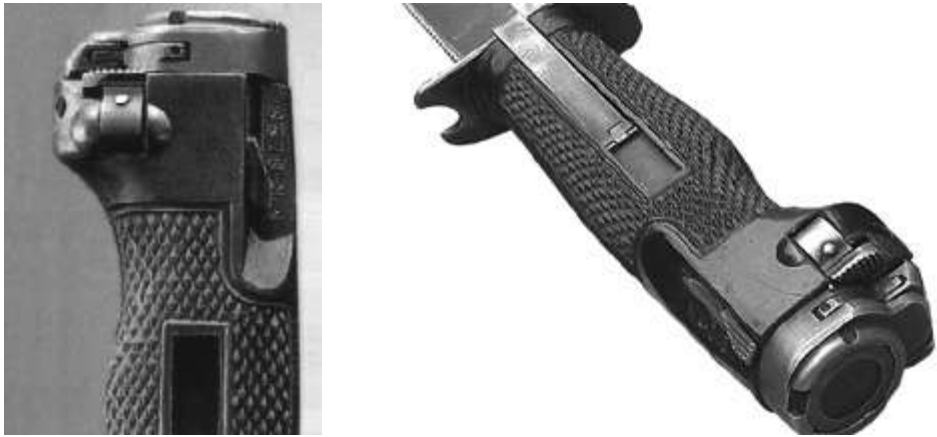
Рис. 5. Пристрій для стрільби ножа розвідника спеціального НРС-2
