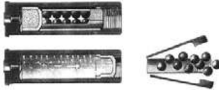
Рис. 3. Патрон для тунельного безшумного револьвера 3
