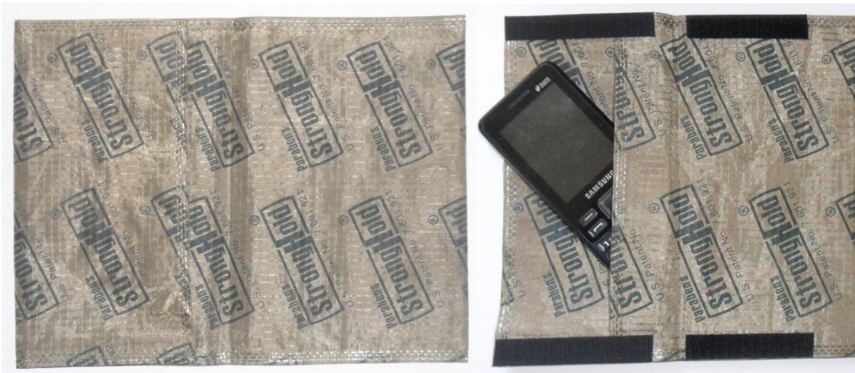
Рис. 4. Сумка (пакет) Фарадея та мобільний телефон
